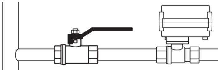
Рис. 2. Схема установки крана шарового с электроприводом.
