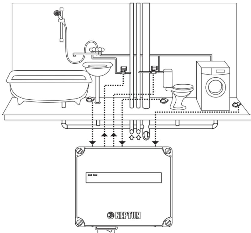
Рис. 1. Пример размещения комплекта в стандартной квартире.
