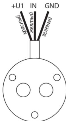
Рис. 5. Маркировка проводов.
