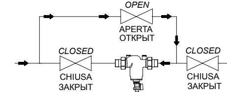
Per effettuare una pulizia più accurata è possibile smontare la rete del filtro e procedere ad un lavaggio. Per togliere la rete è necessario munirsi di una chiave e svitare il tappo di chiusura posto nella parte inferiore, sul quale è avvitato anche il rubinetto di scarico.
