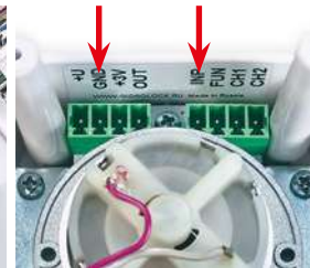
Фото 9. Клеммы подключения проводных датчиков — INP, GND
