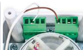
Фото 15. Подключение датчика к электроприводу
