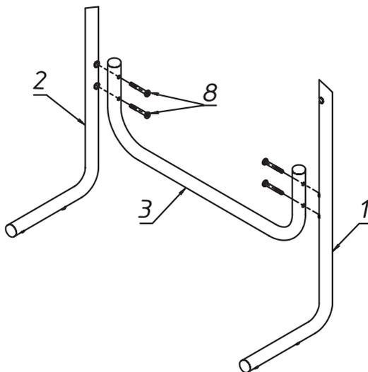
4. Полученную конструкцию установите на собранное основание и зафиксируйте её с помощью винтов (8).
