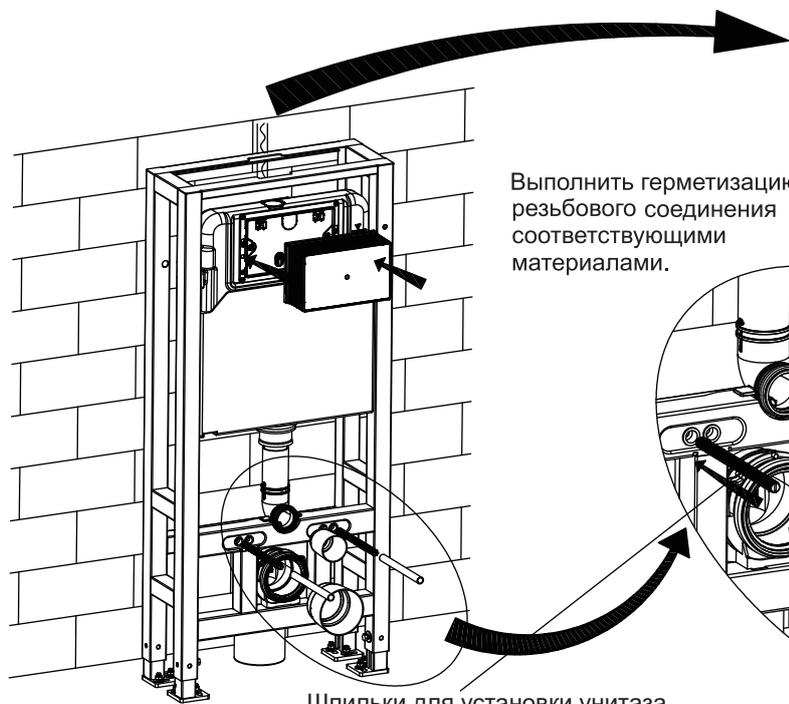
Выполнить герметизацию резьбового соединения соответствующими материалами.
