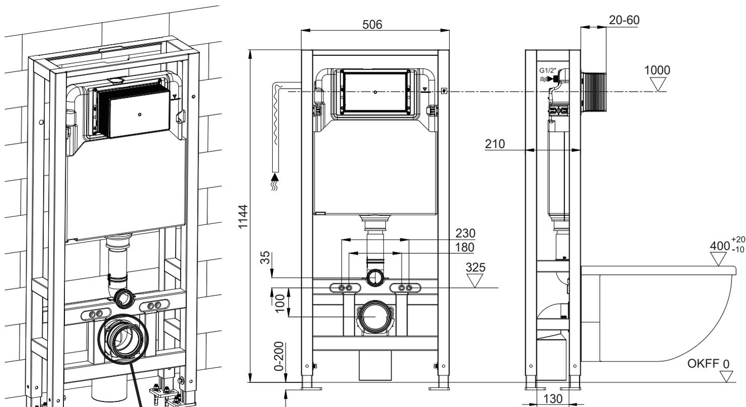
Размер W зависит от положения, в котором фиксируется фановый отвод (рис 1,2).
