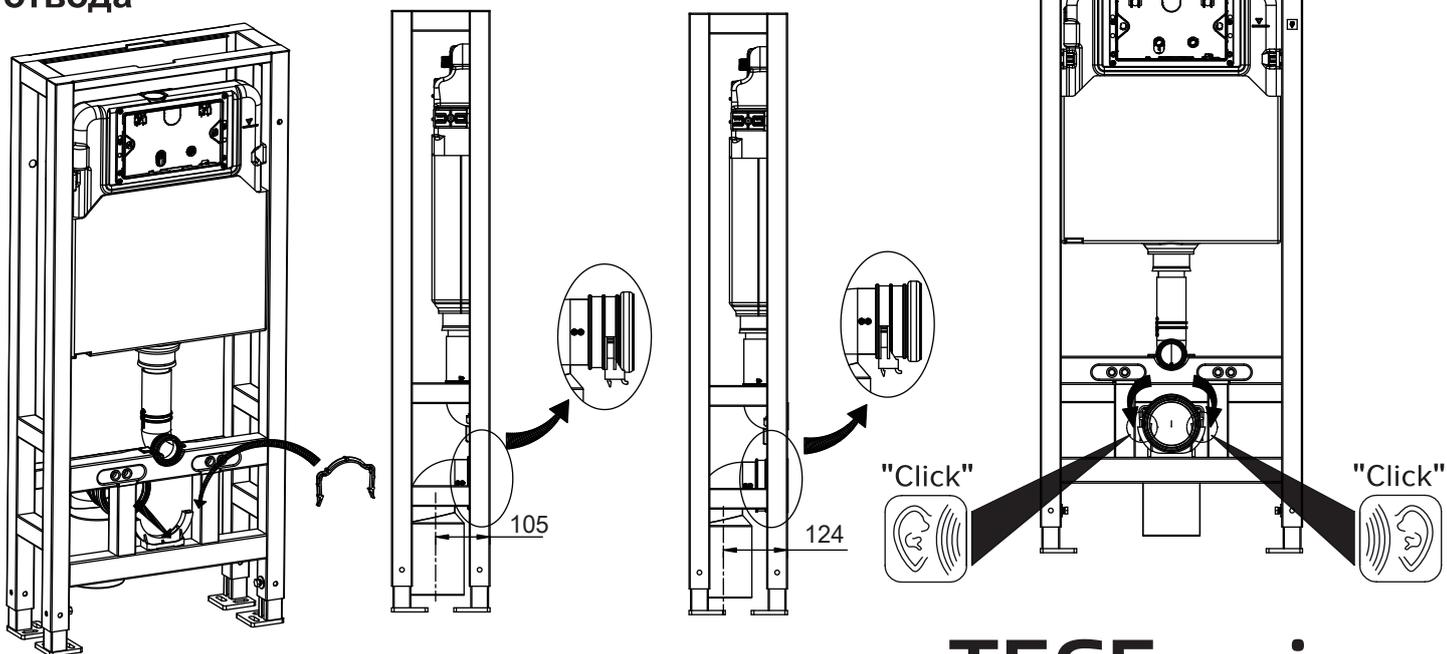
Глубина установки фанового отвода может быть 105 или 124 мм
