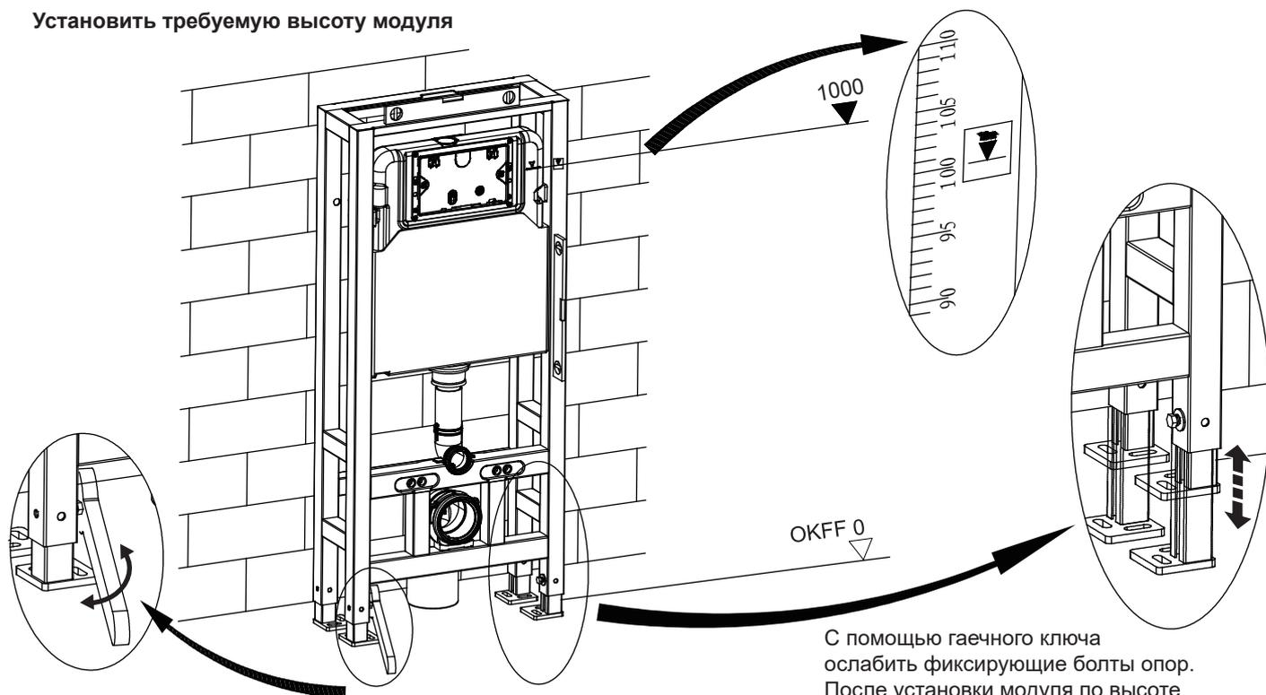
С помощью гаечного ключа ослабить фиксирующие болты опор. После установки модуля по высоте болты необходимо затянуть.
