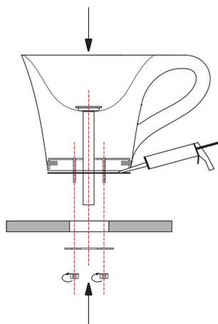
5. Siliconare la base del lavabo prima di appoggiarlo sulla mensola; poi inserite, nelle viti che fuoriescono da sotto, la piastra piccola. Serrate con i dadi in pvc in dotazione. Use silicone to seal the base of the washbasin on the shelf; then put the small plate into the screws that came out from under. Screw with the PVC bolts.
