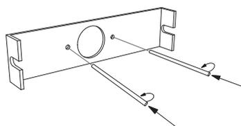
1. Avvitare i perni nella piastra di fissaggio grande in dotazione. Screw the pins in the largest fixing plate included in the package.
