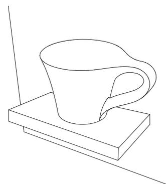
6. Installare ora il vostro sifone sul canotto che fuoriesce dalla mensola. Il lavabo ora è installato! Installare la rubinetteria a muro. Now install your siphon on the extension draining tube that came out of the shelf. The sink is now installed! Install the wall tap.
