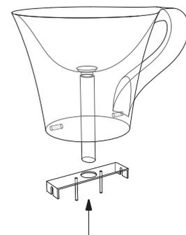
3. Capovolgere il lavabo, e posizionare all'interno la piastra grande con i perni rivolti verso il fondo. Turn the washbasin, and place inside of it the large plate with the pins toward to the bottom.
