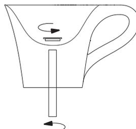
2. Installare la piletta in dotazione sul lavabo, insieme alla prolunga del canotto dritto. Install the included drain on the washbasin, along with the extension draining tube.
